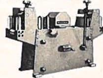
meetapparaat M 80 van 30—80 mm ø, te iijken
